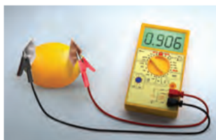
▲ Hình 12.6. Sơ đồ pin chanh
